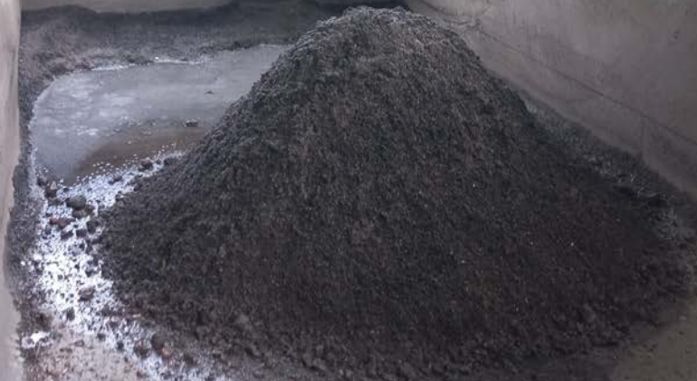
CINZAS GROSSAS: DESCARGA FRONTAL DA GRELHA
