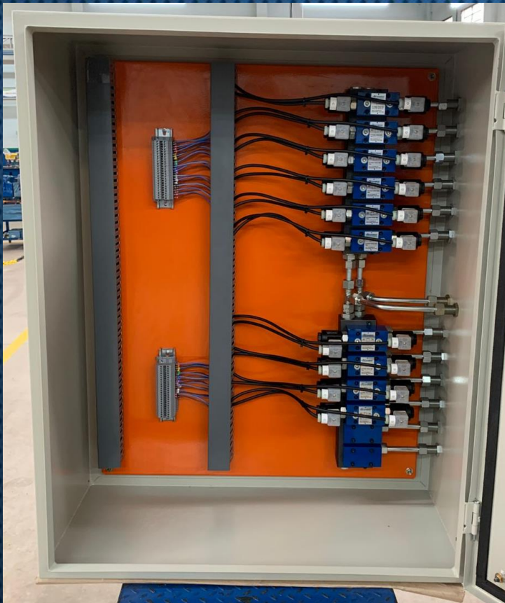
Painel de válvulas automáticas e transmissores de pressão.
